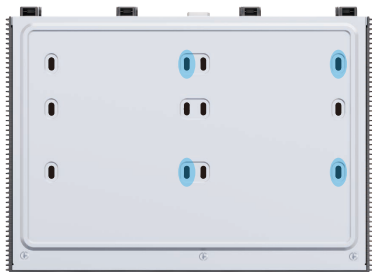
Pour installer un disque dur de 2,5 pouces
