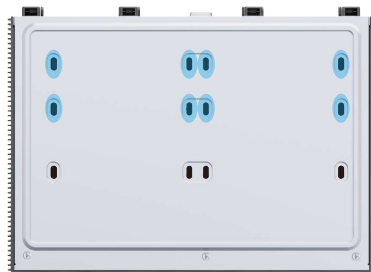
Pour installer un disque dur de 3,5 pouces
